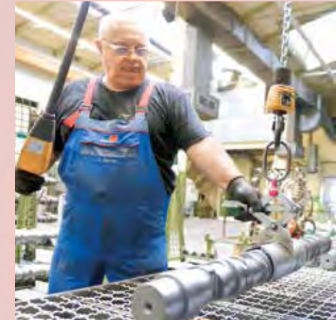
Nach dem Härtetest folgt das Säuberungsstrahlen. Mitarbeiter Günther Dziewas holt die fertigen Nockenwellen aus der Sandstrahlmaschine.
