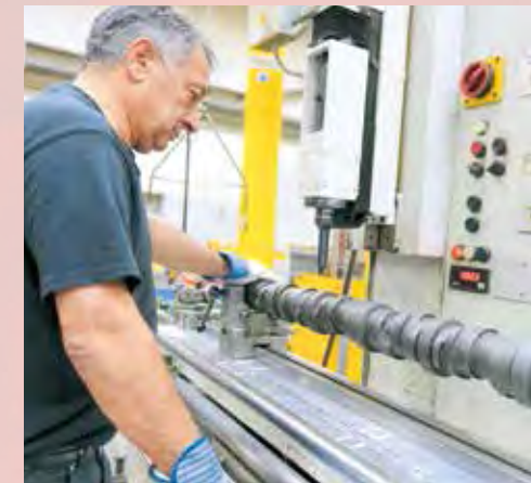
Angelo Caruso prüft mit dem Rockwell-Verfahren den Härtewert der wärmebehandelten Nockenwellen.
