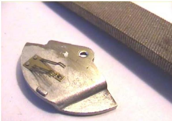
Abb. 8: Grat mit einer Feile entfernen und Kontaktplatte planen
